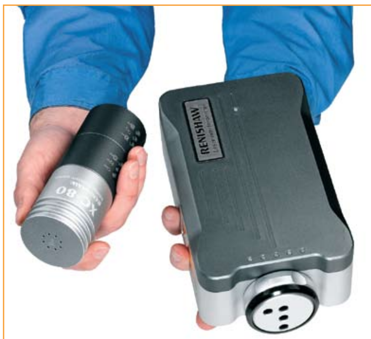
Laser XL-80 (s volitelnou univerzální výstupní clonou) a kompenzátor XC-80
