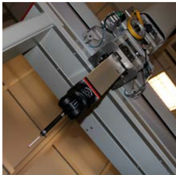
Testa PH20 montato su CMM COORD-3
